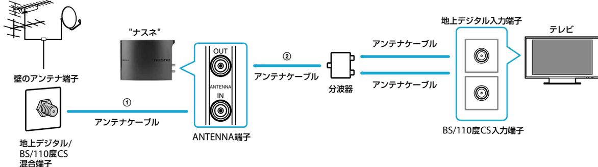
①"ナスネ"のANTENNA IN(アンテナ入力)端子と、壁のアンテナ端子を接続する。
