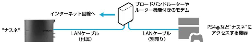
ルーターにLAN端子の空きがない場合は、ハブを使って接続します。ハブはギガビットイーサネットに対応したものをおすすめします。
